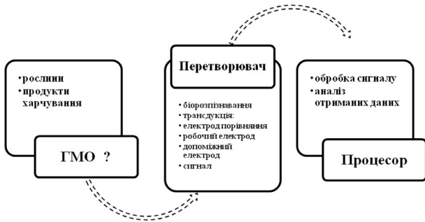
Рис. 1. Складові частини ДНК біосенсора.
